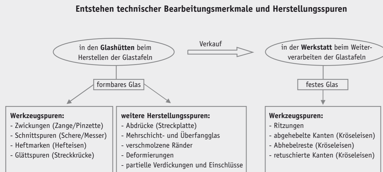
Abb. 27. Bad Windsheim, Marktplatz. Technische Bearbeitungsmerkmale und Herstellungsspuren am Fundmaterial der Glaserwerkstatt.
